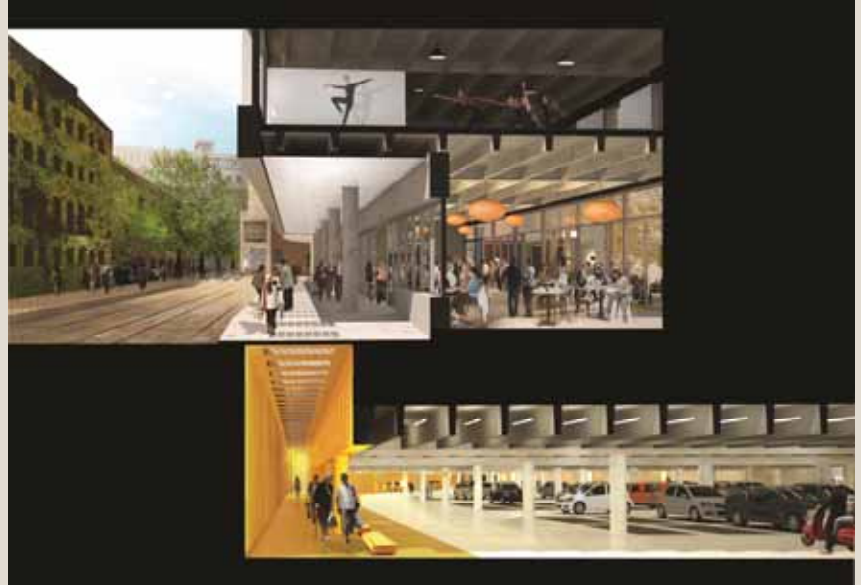
Illustration fra projektkonkurrencen - princip for sammenhæng mellem fodgængerforbindelse i kælder og på terræn
